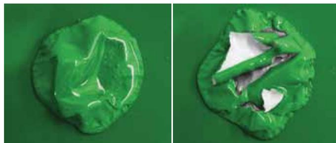
Las imágenes superiores muestran el efecto del Metstrip F3405 en una pintura de dos partes tras 2 minutos de aplicación.
